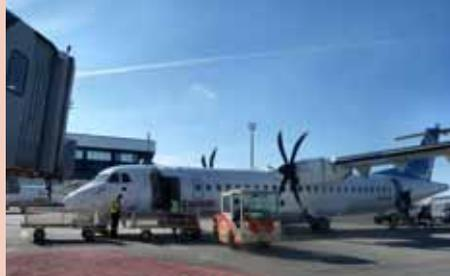
72-500 (en la foto), propulsado por dos motores turbohélice. [www.finnair.com/](http://www.finnair.com/)
