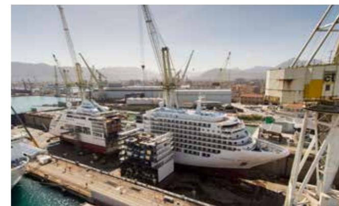
▲ El proceso de alargamiento del Silver Spirit se inició con el corte efectuado en la mitad del barco para, en una segunda etapa, ensamblar la nueva sección, de 15 metros. Barbara Muckermann, directora de marketing de Silversea Cruises, durante la presentación del acto. ▼
