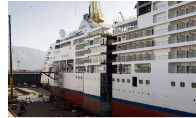
▲ El proceso de alargamiento del Silver Spirit se inició con el corte efectuado en la mitad del barco para, en una segunda etapa, ensamblar la nueva sección, de 15 metros. Barbara Muckermann, directora de marketing de Silversea Cruises, durante la presentación del acto. ▼
