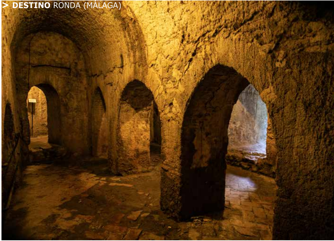
La mina de agua de la Casa del Rey Moro es una de las grandes obras de ingeniería hidráulica construidas en el Reino Nazarí durante el siglo XIV. Extraía agua del río para suministro de la población en caso de asedio.
