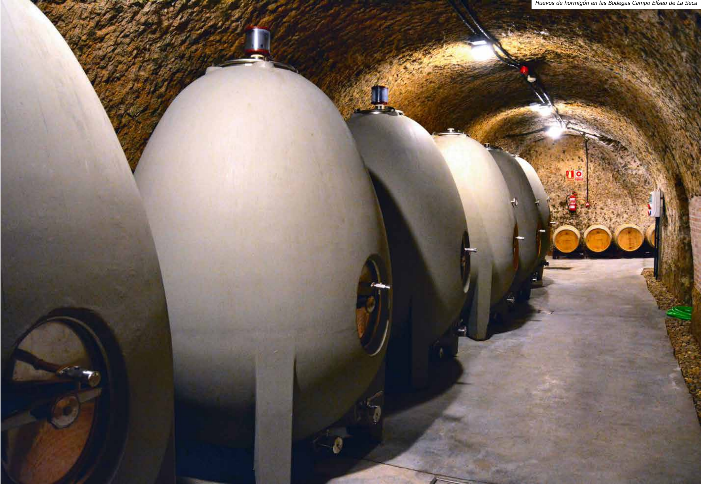
Huevos de hormigón en las Bodegas Campo Elíseo de La Seca
