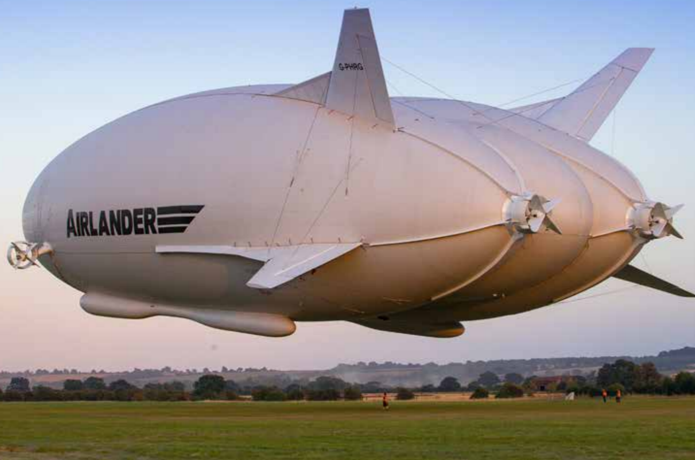
▲ El Airlander 10 vuela a una altura para la que no es necesario presurizar la cabina por lo que goza de inmensas ventanas y suelos de vidrio.
